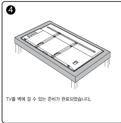
브래킷을 TV 뒷면에 배치한 후 TV 뒷면에서 제거한 4개의 VESA 나사를 사용해서 브래킷을 고정합니다.
